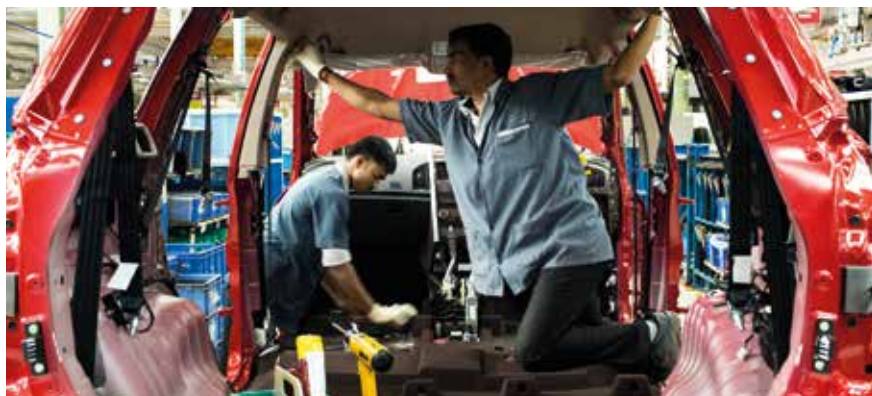
Medarbejdere installerer indvendige paneler i XUV 500 SUV på Mahindra & Mahindras fabrik i Chakan, Indien.
